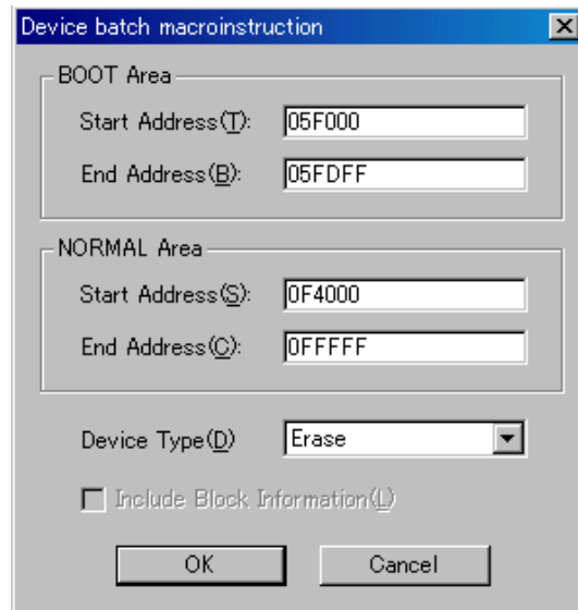
図6. 1 デバイス一括マクロコマンドパラメータ入力ダイアログ
